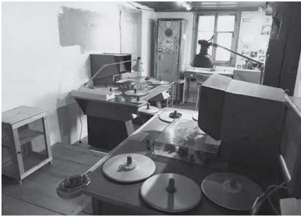
2 Schneidetische Steenbeck rechts Jahrgang 1964, links Jahrgang 1984, hinten in der Mitte Rotosyn Filmtonbandmaschine
